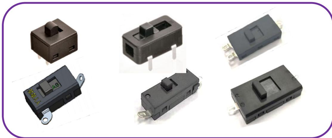
直筒式电吹风开关应用特点：功率约1400-2200W,以滑动开关为主，2档/3档/4档可供选择，开关有焊接或PCB端子适用不同安装方式，开关直接承受主负载或弱负载+可控硅承受主负载，开关可独立安装在PCB上
